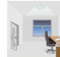
Nach der hold-time dimmt die Leuchte auf das Stand-by Level solange der Tageslichtschwellschwert unterschritten ist
