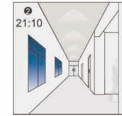
Das Licht dimmt auf Stand-by Level nach Ablauf der Hold-time
